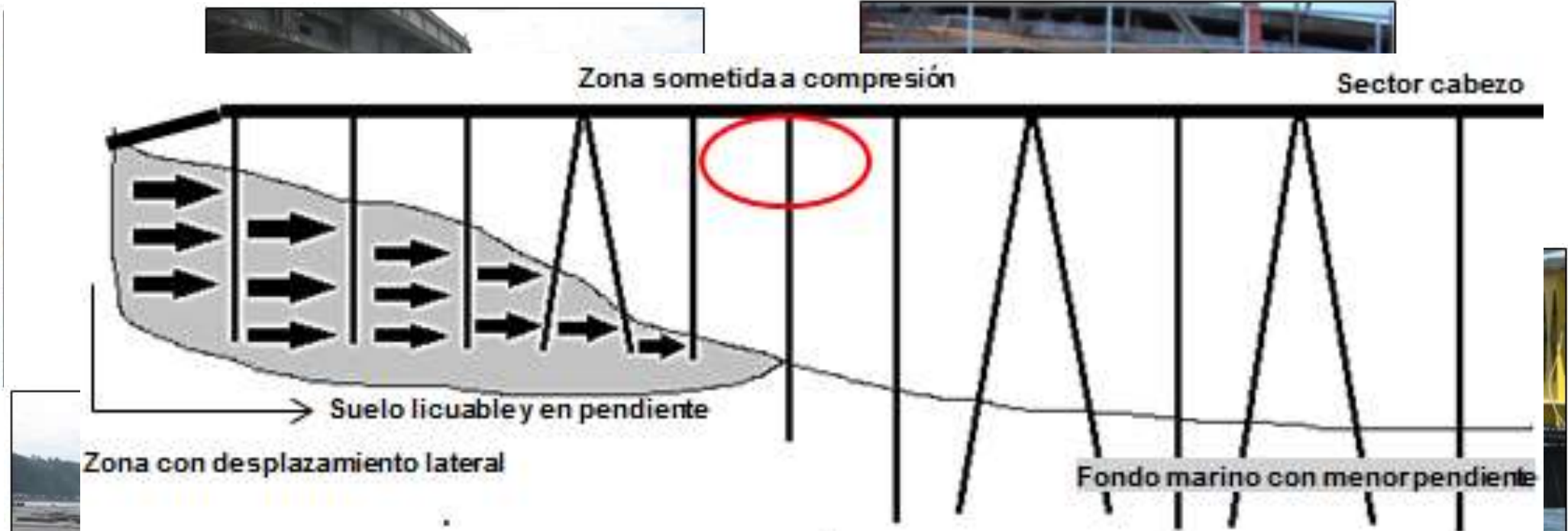
Figura 5.4: Compresión de zona del muelle asociada al fenómeno de desplazamiento lateral.
