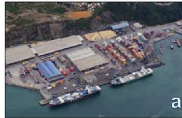
Figura 3.16: Tipos de muelle: a) Muelle marginal; b) Muelle perpendicular.
